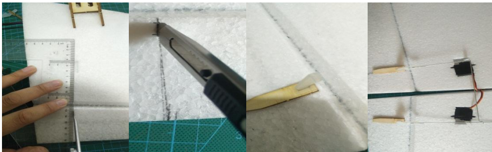
舵角安装：先用美工刀在图示位置开口。5-8mm 长即可，深度 6mm。接下来在开口附近涂胶，开口内部需要涂胶，并将上一步中做好的舵角按图粘合，注意前缘与舵面的棱对齐。
