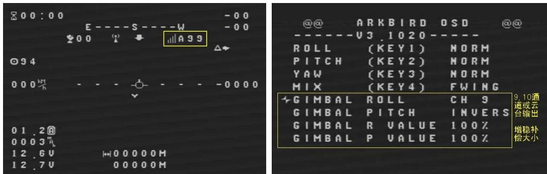
OSD 界面自动显示 RSSI 强度 A99。OSD 菜单新增一项 Flight / Mix / Gimbal，可以将 9、10 通道输出设置为舵机云台输出（此时由 7、8 通道控制），补偿正反和控制量大小可调。
