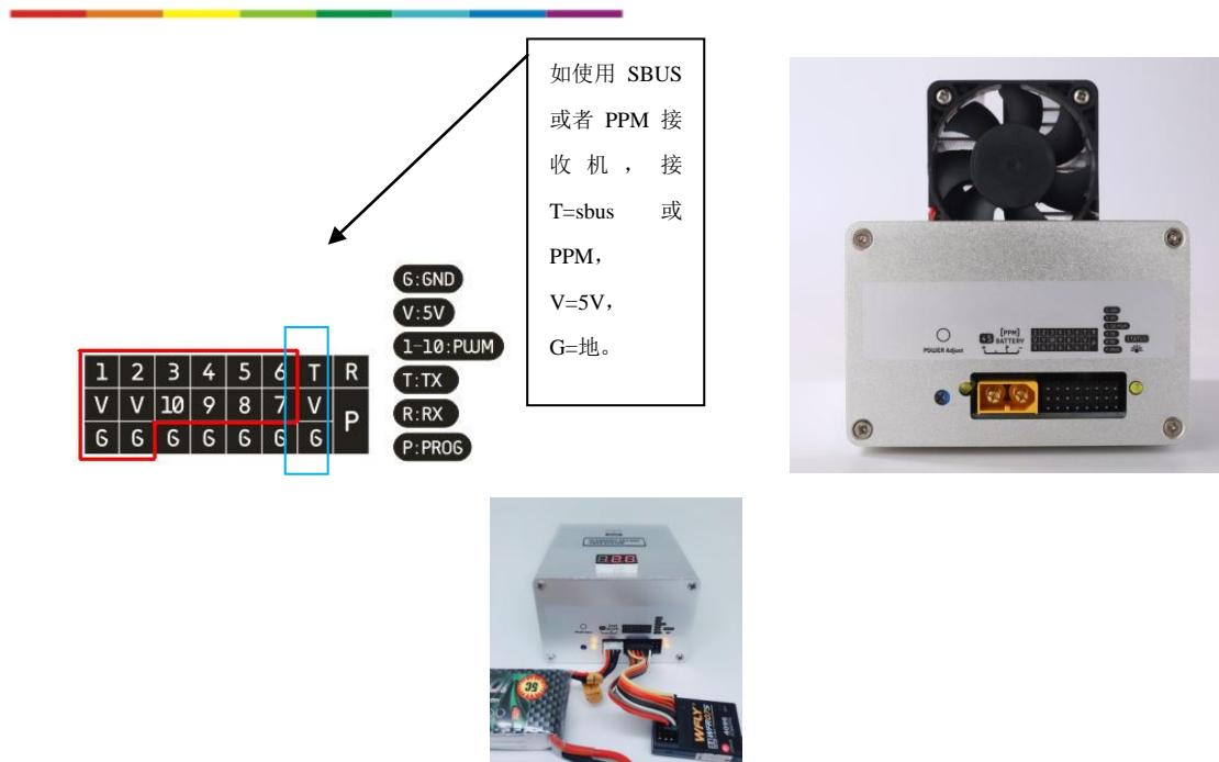
1. 转发模式将遥控器接收机的信号转发至 433 接收机上，适合将 433 发射机放远以避免干扰图传，使用三脚架 433 发射机天线竖直安装于离地 1.2 米高以上。
