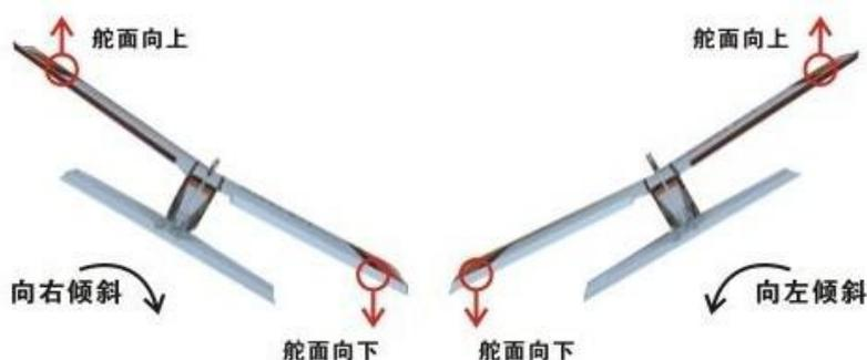
如果给出的辅助量相反，请在菜单“辅助量正反与混控”调节“横滚控制量”到“反向”。
