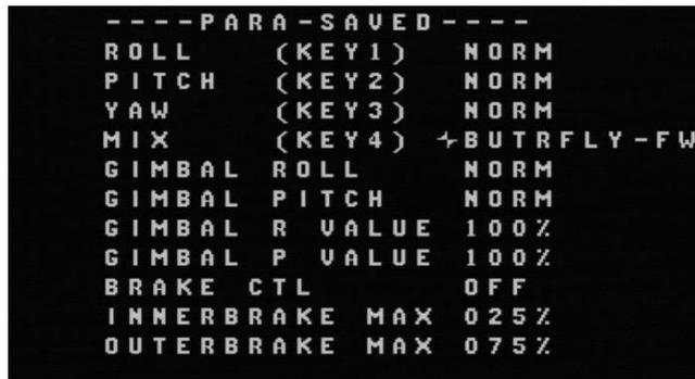
当“Mix (KEY4)”被设置为“飞翼蝴蝶刹车”混控时，Flight 菜单自动变成“Brake”等选项，1、2、4、7 通道输出为蝴蝶刹车混控，由四个舵面控制飞机的横滚、俯仰、方向和刹车（减速），
