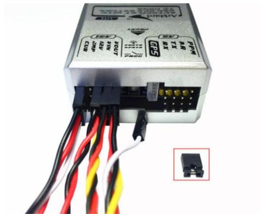
2. 如动力电不是 3S 电池, 请将动力和视频部分独立供电。拔掉跳线帽, 单独用一颗 3S 电池插入第三排“视频电”端口 (建议 800mah-1400mah), 给图传、摄像头和飞控 OSD 12V 模块供电。
