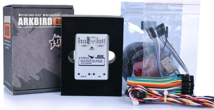
ARKBIRD 2.0 LITE 飞控是专为固定翼打造的高精度平衡仪。它一方面能将数据信息（OSD）叠加到视频上，同时又能高精度控制飞行器平衡、返航等动作。
